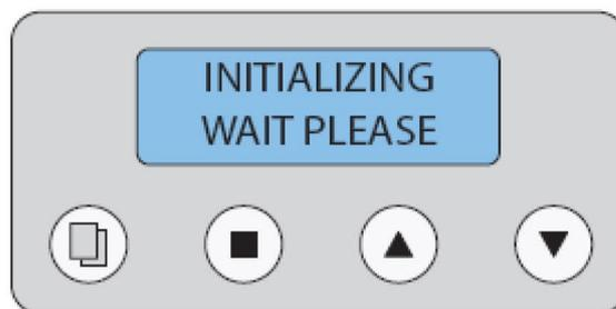
2. Appuyer sur le bouton « MENU » pendant trois secondes par accéder à la programmation intérieure du système. Appuyez  $\wedge$  et  $\vee$  pour afficher les différents paramètres de programmation. Appuyez sur « REGEN » pour les régler. Appuyez sur la touche « REGEN » pour valider la modification. Les paramètres dans le MENU sont :
